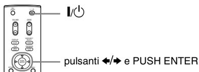
Quando il sistema è in questa modalità, è possibile attivarlo mediante il pulsante I/⏻ sul telecomando.
