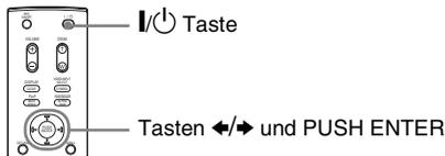
Wenn sich das System in diesem Status befindet, kann es mit der Taste I/⏻ auf der Fernbedienung eingeschaltet werden.
